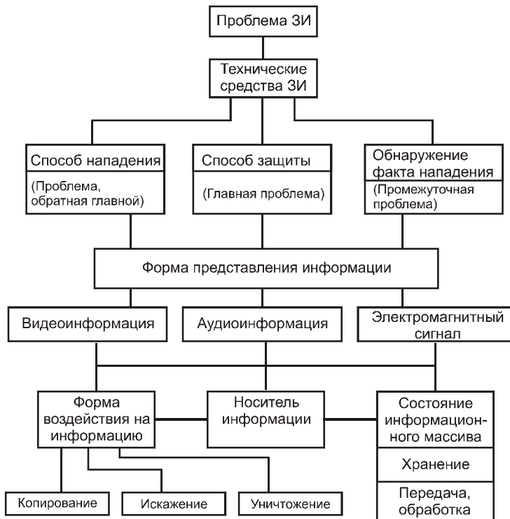
Рис. 15.4. Семантическая схема проблемы ЗИ с помощью технических средств с позиций структурной иерархии
